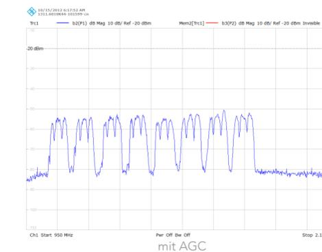
Umsetzer mit AGC-Regelung bieten eine hohe Planungssicherheit bei der Berechnung der Anlagendämpfung über alle Satelliten hinweg.
